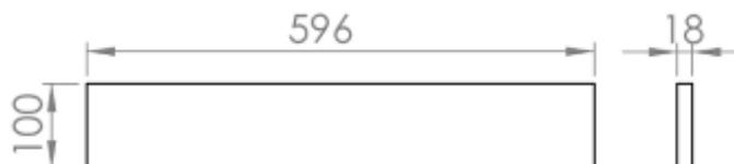
**Remarque :** la longueur maximum est 596mm, mais pour faciliter le montage, choisissez un peu moins, comme par exemple 595mm (permet de laisser un jeu d'1mm lors du montage entre le support longitudinal et le cadre).
